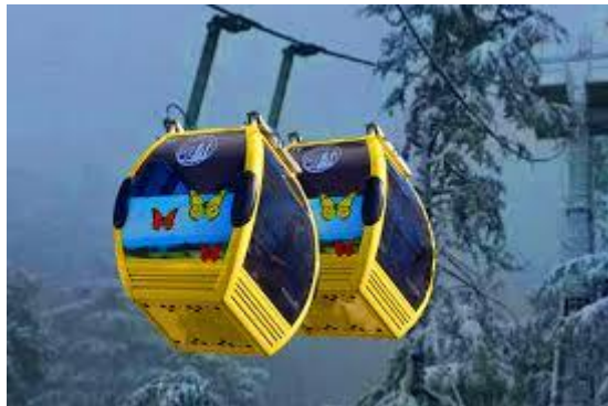
Ilustración 5. Teleférico monocable reversible de Shimla, India.
