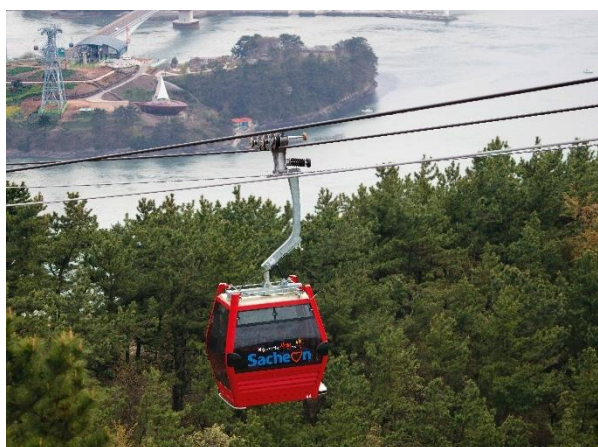
Ilustración 7. Teleférico bicable 2S unidireccional de Sacheon, Corea del sur.
