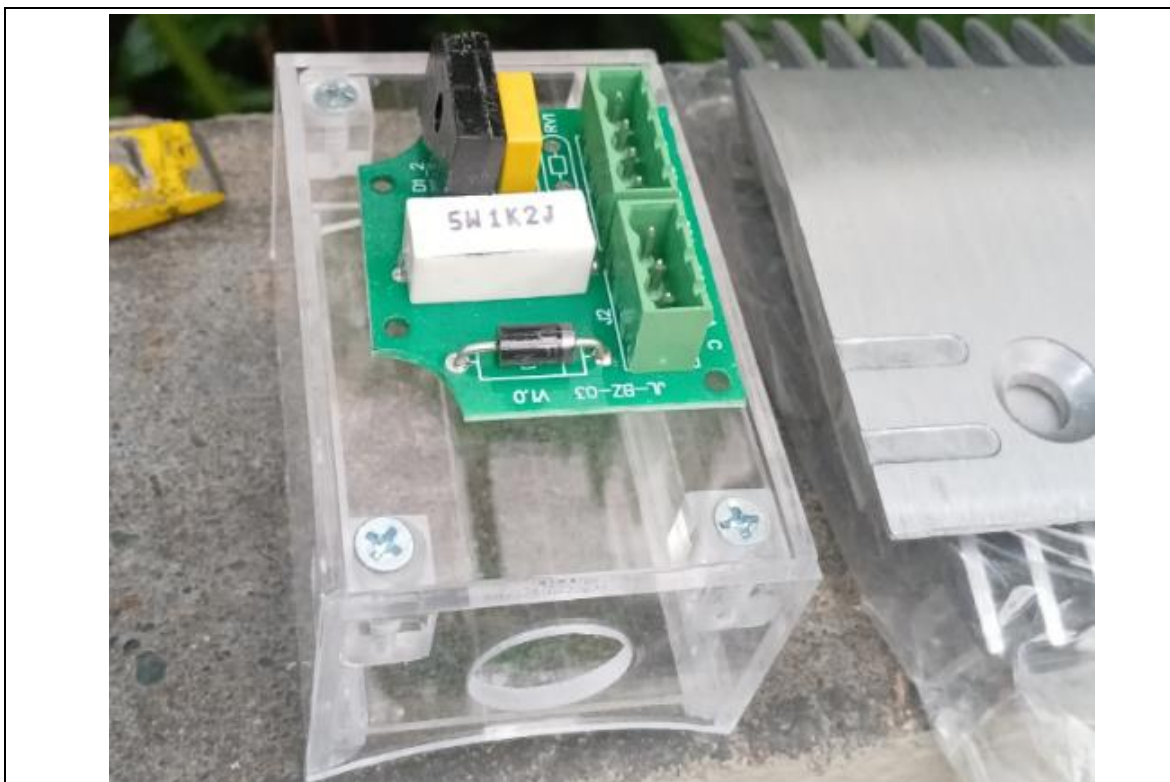
Imagen 1. Cambio de caja y tarjeta de circuitos bobina de freno y peines metálicos.
