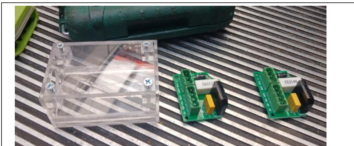
Imagen 3. Cambio de caja y tarjeta de circuitos bobina de freno.
